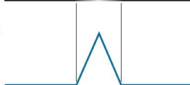
A Roof Edge
