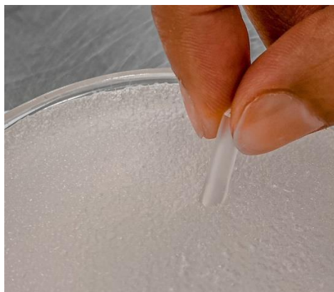
شكل رقم (2) يوضح شكل خطوط نقل الدم أثناء عملية الغمس
