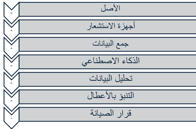
شكل (10-2) آلية عمل النكاء الاصطناعي في إدارة الصيانة
