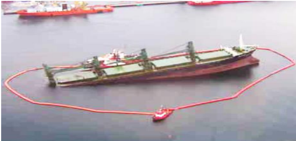
الشكل رقم (٥): حاجز تطويق تم ربطه حول حطام سفينة غارقة جزئيا لاحتواء أي تسربات محتملة من وقود السفن.
