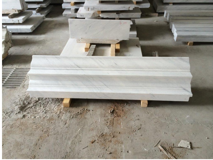
شكل (٤-٤) Georgia Marble™ – إفريز شيروكي أبيض بعد الترميم والقطع لإعادة تركيبه على مبنى جديد
