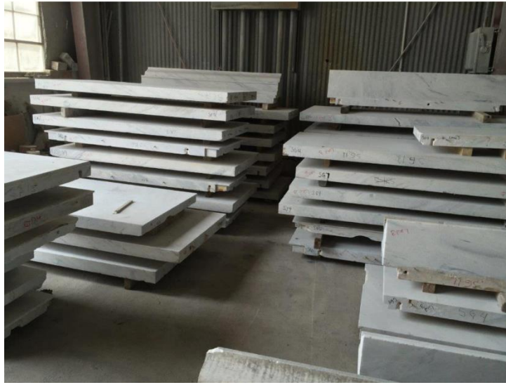
شكل (٣-٤) Georgia Marble TM – ألواح كسوة واجهة مبنى من نوع White Cherokee تم تفكيكها من مبنى قائم يخضع للترميم.
