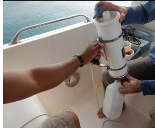
شكل ٣ آلية جمع العينات لمياه البحر وعند نقاط تصريف الرجيع الملحي
